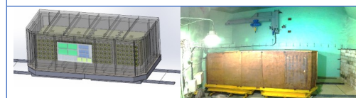
Установка Нейтрино: измерения спектра реакторных антинейтрино на различных расстояниях.
