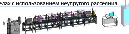
Спин-эхо малоугловая установка SESANS: исследования крупномасштабных объектов биологии, коллоидной и супрамолекулярной химии, пористых и мембранных систем, магнитных многослойных структур.
