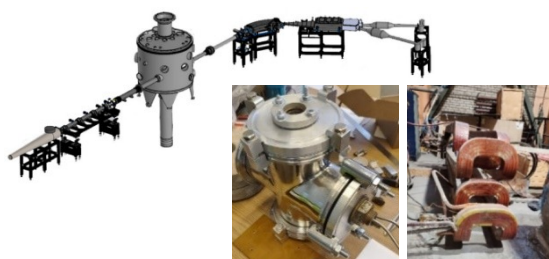
Масс-сепараторный лазерно-ядерный комплекс ИРИНА: получение радиоактивных ионных пучков нейтронно-избыточных короткоживущих изотопов для ядерно-физических исследований, прикладных исследований по физике твердого тела, отработки методов получения радионуклидов для медицины.
