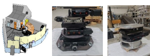
Порошковый многодетекторный дифрактометр тепловых нейтронов D3: получение точного знания об атомной структуре материалов и анализа магнитной структуры кристаллов.
